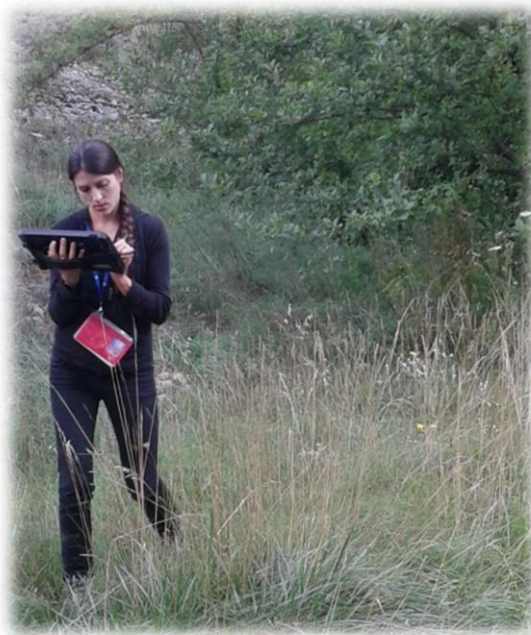
Figure 7 : Saisie du contour d'une mare par acquisition GPS
